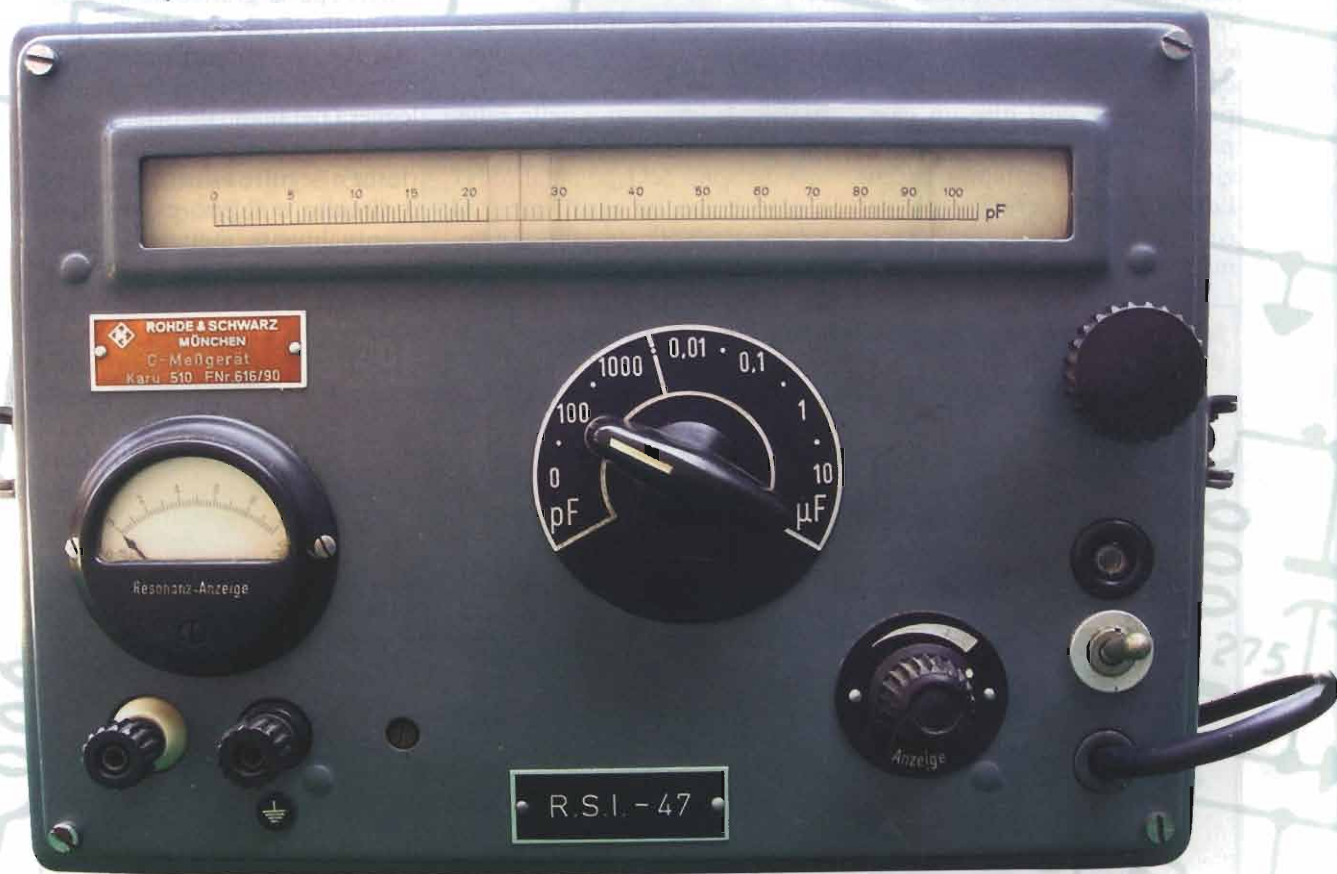
figura 1: Vista frontale del capacimetro ROHDE & SCHWARZ Karu510
